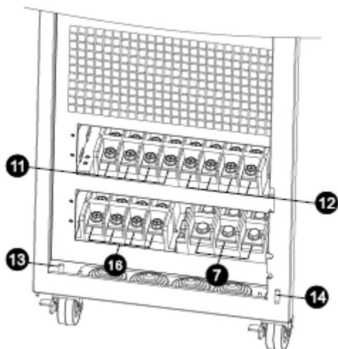
图 11: HV 60KL / HV 80KL 双输入输入/输出端子
