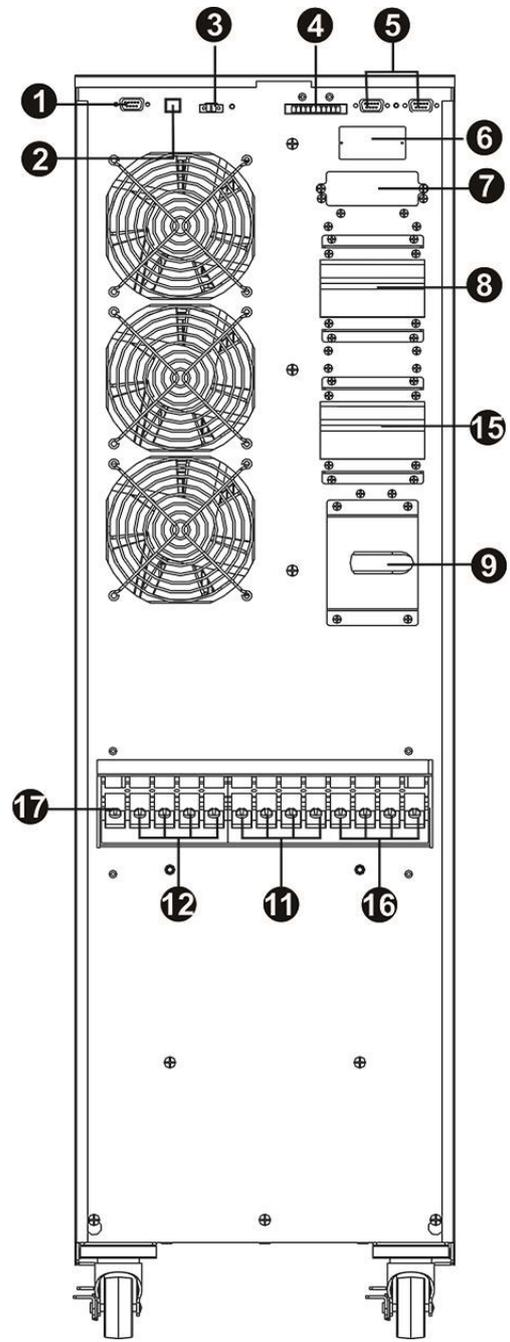
图 5: HV 40K(L)双输入背板
