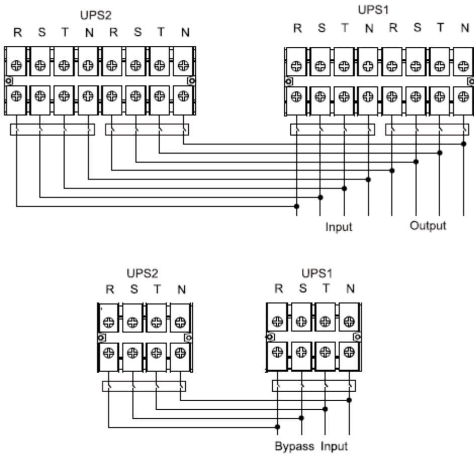
**HV 60KL/80KL 双输入并机系统接线图**
