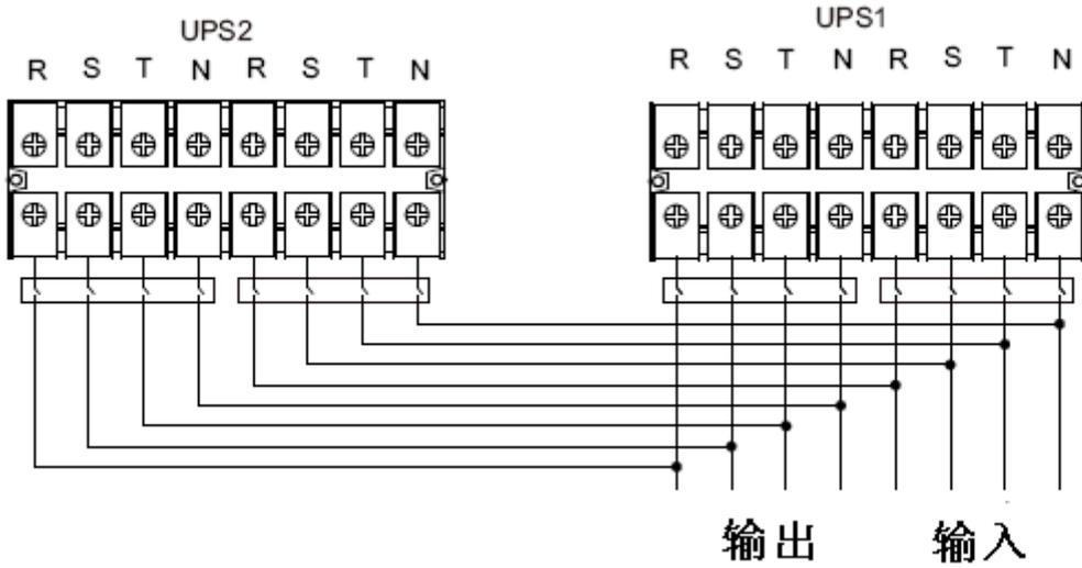
**HV 30K(L)/40K(L) 并机系统接线图**
