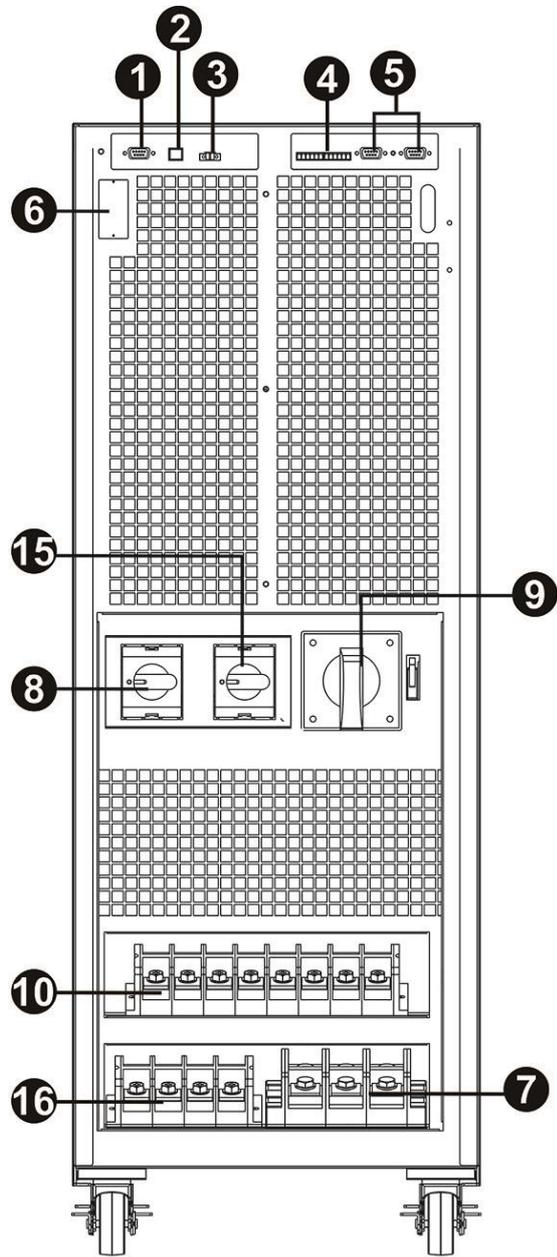
图 10: HV 80KL 双输入打开来前面板视图
