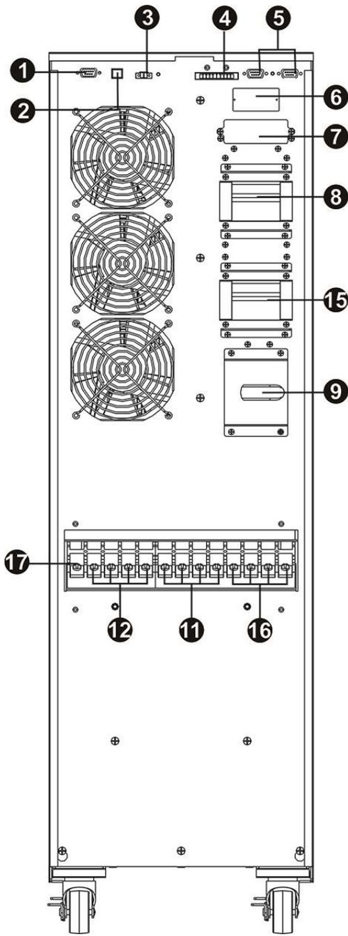
图 4: HV 30K(L) 双输入背板
