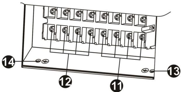
图 3: HV 30K(L)/ HV 40K(L) 输入/输出端子
