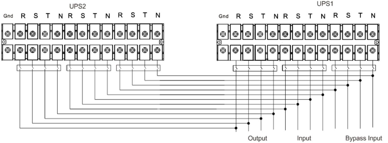
**HV 30K(L)/40K(L) 双输入并机系统接线图**
