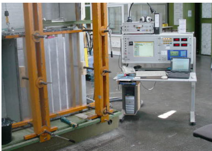
Abbildung 1 Geschäumte Fugen in Prüfvorrichtung für Längsfugen nach DIN 18542, aufgebaut auf dem Fensterprüfstand.
