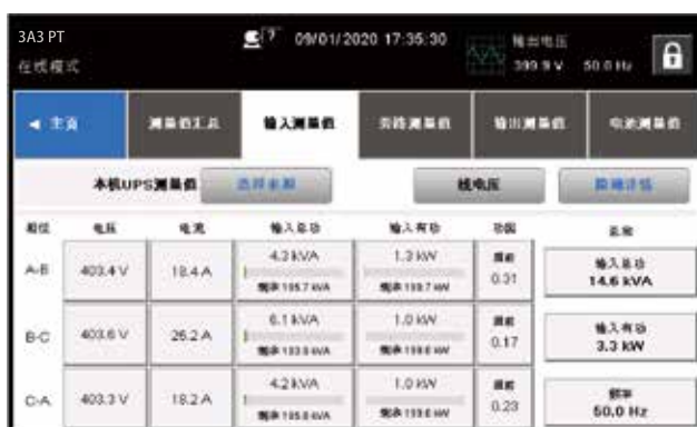
图6-11：输入测量值详情屏幕
