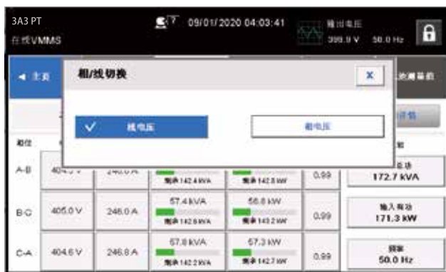
图6-12：选择电压显示模式屏幕
