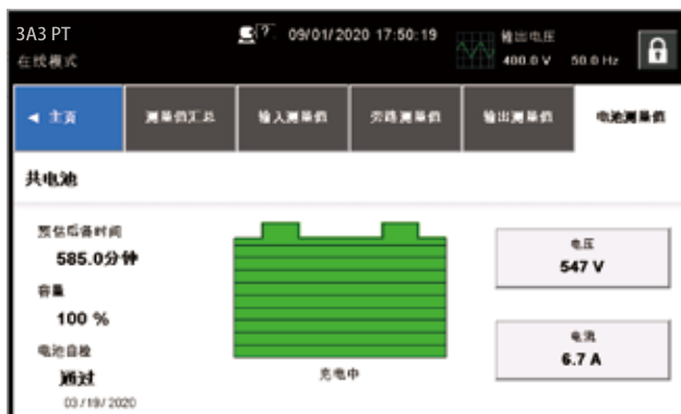
图6-22： 电池测量值屏幕
