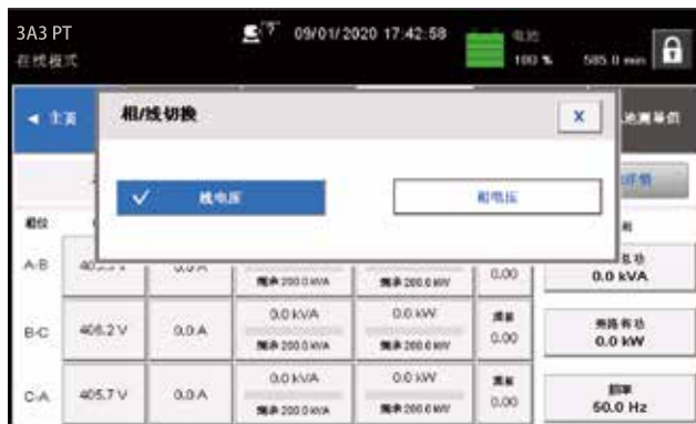
图6-16： 选择电压显示模式屏幕
