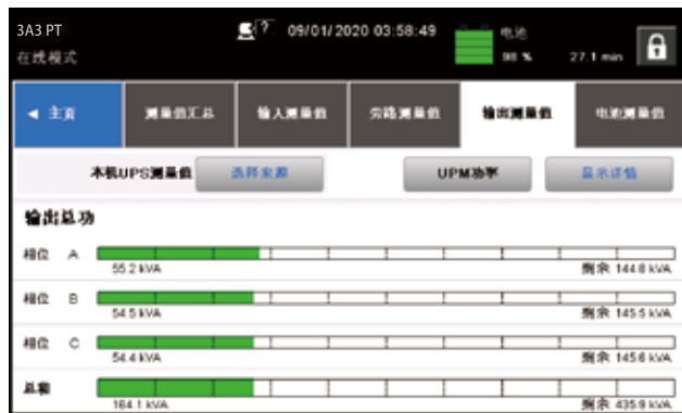
图6-18： 输出测量值屏幕
