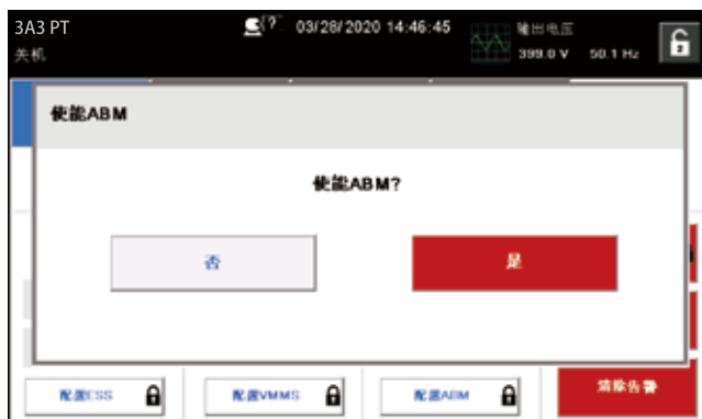
图6-32： 使能高级电池管理(ABM) 指令确认屏幕
