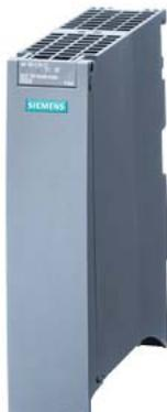
SIMATIC ET 200MP. PROFINET 输入输出设备 接口模块 IM 155-5 PN HF, 针对 ET 200MP 电子模块; 直至 12 个输入输出模块无需 PS; 直至最多 30 个输入输出模块带附加 PS; 内置 2 端口交换机; RJ45 共享设备; MRP; IRT  $\geq 0.25\text{ms}$ ; 节拍同步 固件更新; I&M0...3; 按优先级启动, S2 冗余; 共享设备, 带 4 个控制器适用于运行与有源背板总线一起 (从固件 V4.4 起)
