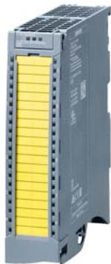
SIMATIC S7-1500, F 数字输出模块, F-DQ 8x 24VDC 2A PPM PROFIsafe; 35mm 结构宽度; 至 PL E(ISO 13849-1)/ SIL3(IEC 61508)
