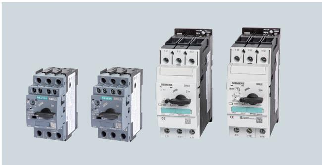
3RV6/3RV5 断路器为紧凑型限流电动机起动保护断路器，可用于三相感应电动机（交流 400 V 时功率最大至 45 kW）和其他负载（额定电流最大至 100 A）的开合和保护。
